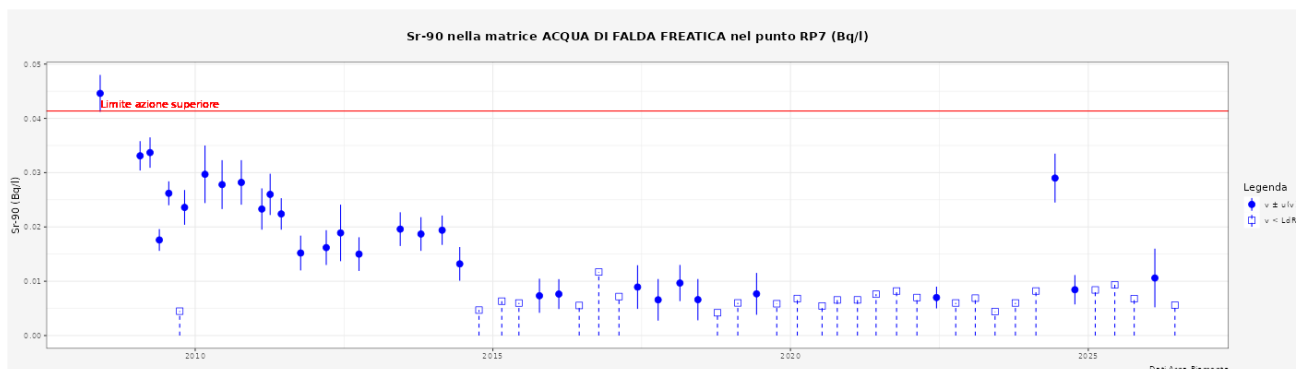
Figura 5.3. Andamento della concentrazione di Sr-90 nell'acqua di falda superficiale campionata nel punto RP7 (Bq/l) – La linea rossa rappresenta il limite di azione pertinente.
