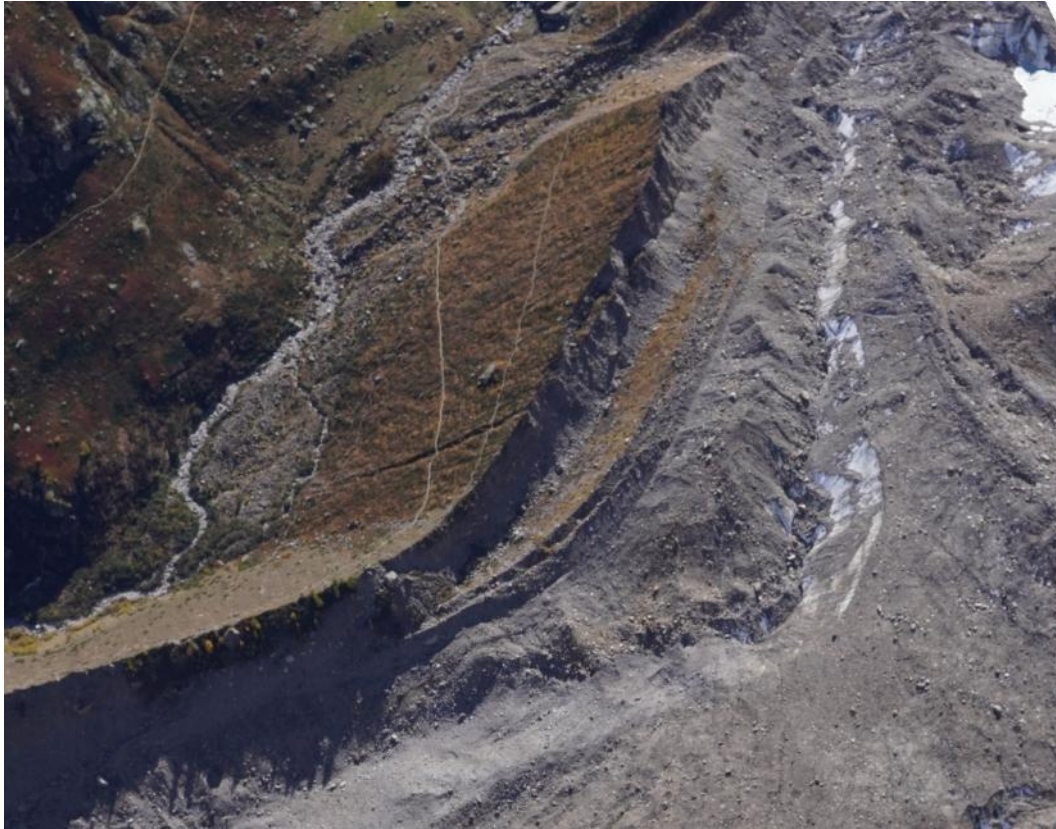
Figura 99 – Scivolamento della morena destra a monte della biforcazione; lo scivolamento, già presente in tempi storici, ha mostrato una chiara riattivazione negli ultimi anni con abbassamenti che sono passati da circa 1m/anno a 5m/anno. Immagine da elicottero del 10/10/2025, ripresa da Nord verso Sud.
