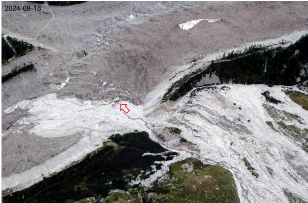
Figura 107 – Area dell’inghiottitoio come si presentava nel settembre 2024, vista da elicottero. La breccia già intercettava interamente l’idrografia locale dei torrenti Castelfranco e Piccolo Fillar; incominciavano a vedersi le scarpate in ghiaccio concentriche, ma non si osservava ancora la grande cavità chiaramente visibile oggi.
