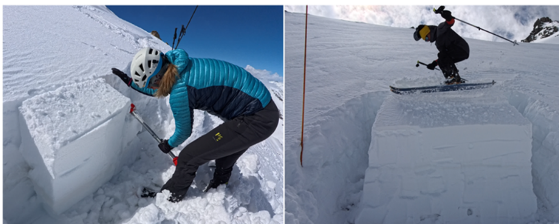
Figura 3.23: Test di stabilità del manto nevoso. A sinistra l'ECT (Extended Column Test ovvero test della colonna estesa), a destra l'RB (Rutschblock ovvero test del blocco di slittamento)
