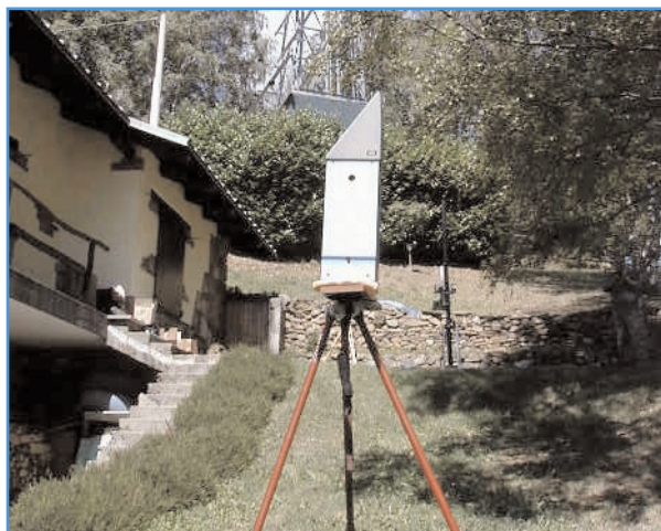
Fig. 30 Sistema di monitoraggio in continua (centralina) per la misure del campo elettromagnetico a radiofrequenza.
