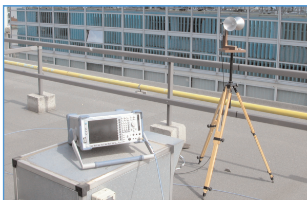
Fig. 29 Misura in banda stretta dei livelli di campo in prossimità di impianti per telecomunicazioni: l'antenna viene collegata ad un analizzatore di spettro che permette di determinare i contributi al valore globale di campo elettromagnetico dovuti alle singole sorgenti.
