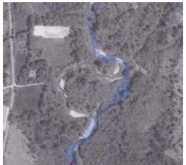
Nella parte terminale del tratto si è verificato un taglio di meandro, in azzurro l'andamento attuale del corso d'acqua (L'ortoimmagine di destra è del 1991).
