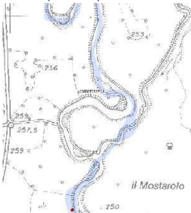
Nella parte terminale del tratto si è verificato un taglio di meandro, in azzurro l'andamento attuale del corso d'acqua (L'ortoimmagine di destra è del 1991).
