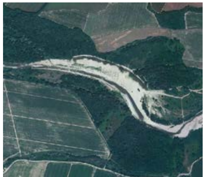
Operazioni di scavo in alveo per lo spostamento dello stesso visibili nelle ortofoto 2012.
