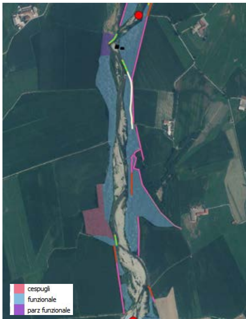
Opere idrauliche e vegetazione divisa per tipologia nel tratto.
