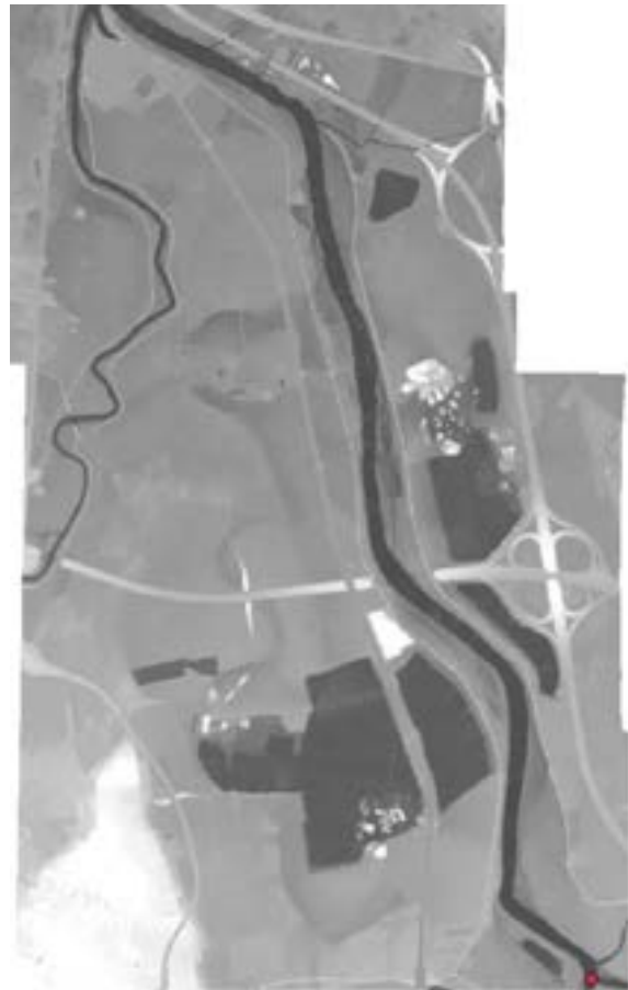
DTM derivato da lidar che evidenzia le forme di meandri relitti in sinistra dell'attuale alveo
