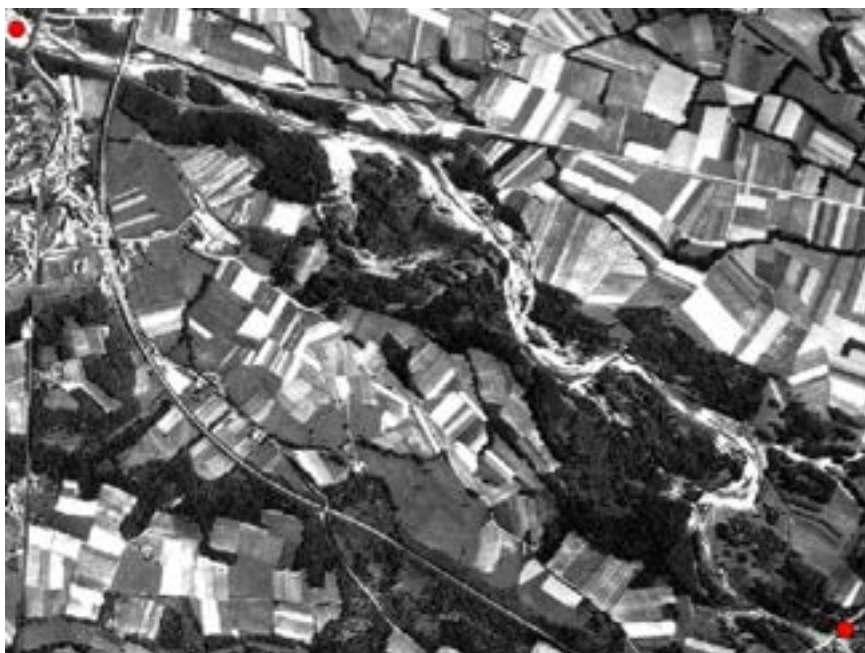
L'alveo come si presentava sulle fotografie aeree del 1954: nell'ultima porzione anastomizzato (indice anastomizzazione dell'alveo '50 per il tratto pari a 1.4, dell'ultima porzione 1.9).
