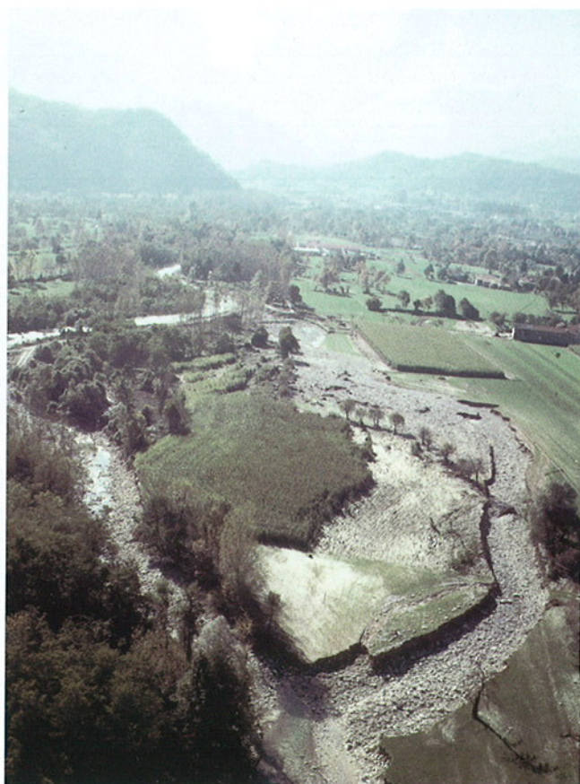
Fig. 12. Torrente Pesio. Ripresa aerea degli effetti erosivi provocati dalle acque di esondazione.
