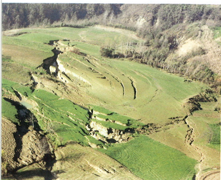
Fig. 4. Comune di Rocca Cigliè, regione Molle. Ripresa aerea di un ampio settore di versante coinvolto in uno scivolamento planare arrestatosi in una fase di evoluzione "intermedia".
