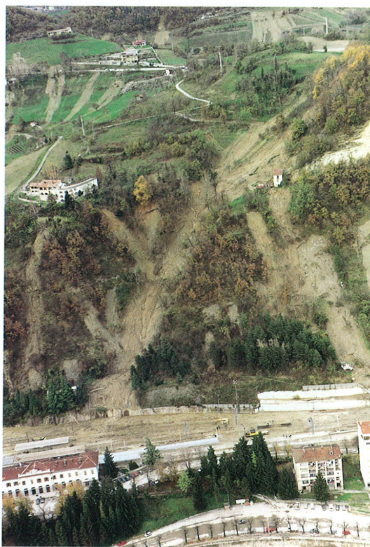
Fig. 87. Città di Ceva, stazione ferroviaria. Nell'immagine, ripresa da elicottero, sono rappresentati gli effetti derivanti dall'attivazione di diffuse frane superficiali sul versante sud della Rocca del Forte. Le colate detritiche hanno gravemente danneggiato la sede ferroviaria, infrastrutture ed edifici posti nelle vicinanze.
