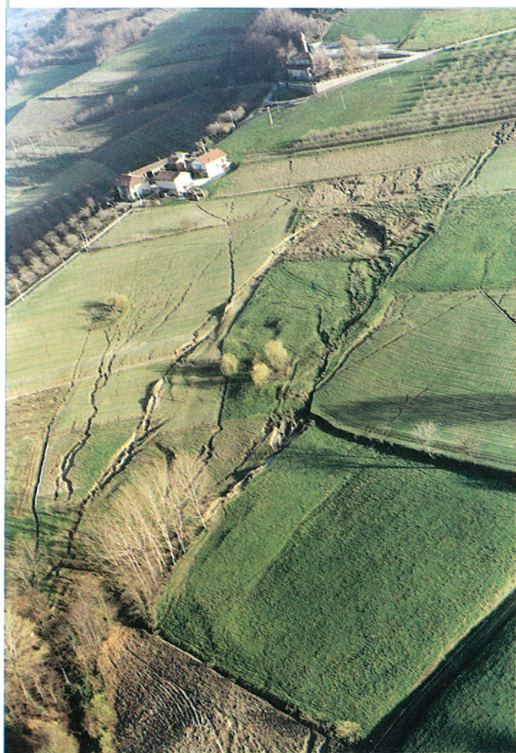
Fig. 13. Immagine in ripresa obliqua di uno scivolamento planare apparentemente arrestatosi in una fase iniziale, seppure ben delimitato da fratture laterali.
