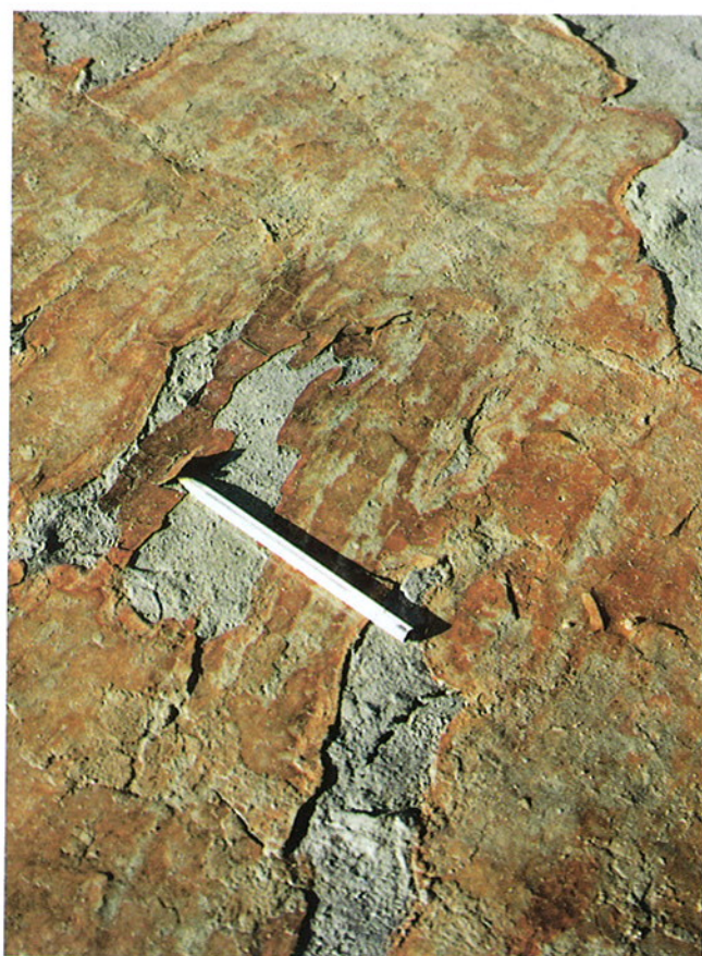
Fig. 34. Particolare del piano di scivolamento in un movimento a componente planare nel quale è evidentissima la presenza di un "crostone" di color ocra legato ad ossidazione per preesistente circolazione idrica entro il substrato.
