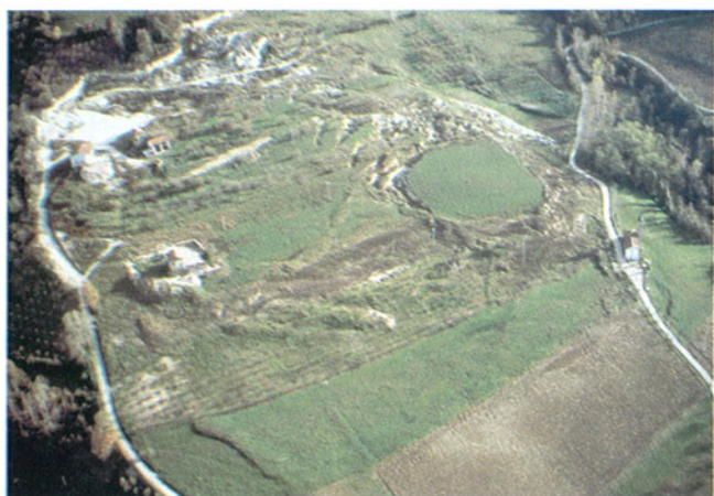
Fig. 16. Cissone, Località Madonna della Cassina. Vista aerea generale della frana per scivolamento planare: in alto la scarpata principale, in basso le ondulazioni derivate dalla compressione e da locale sovrascorrimento.
