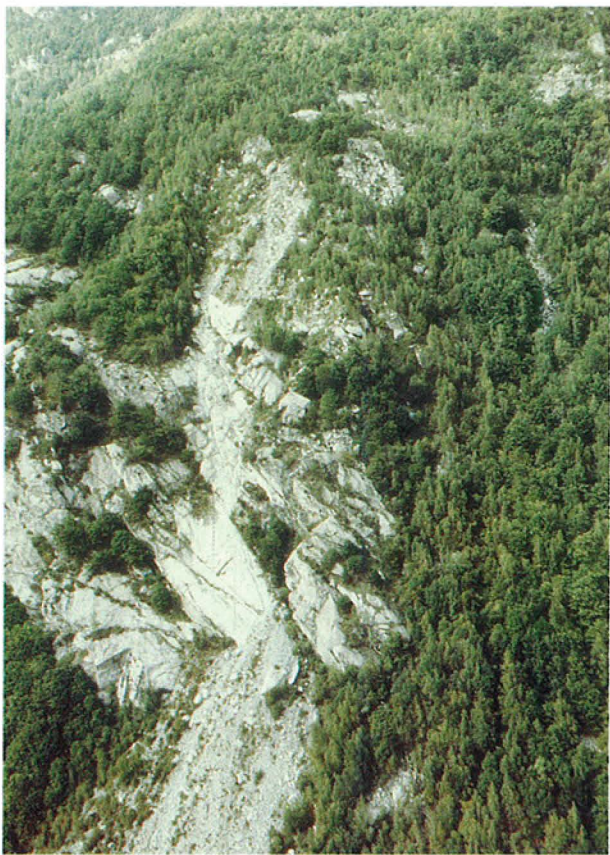
Fig. 7. Porzione frontale-inferiore della zona C del settore di Bertodasco. Al centro dell'immagine è evidente il contatto tra substrato roccioso e la sovrastante massa detritica in movimento. Alcune centinaia di metri più in basso è posta la strada di fondovalle difesa, in questo punto, da una galleria paramassi.
