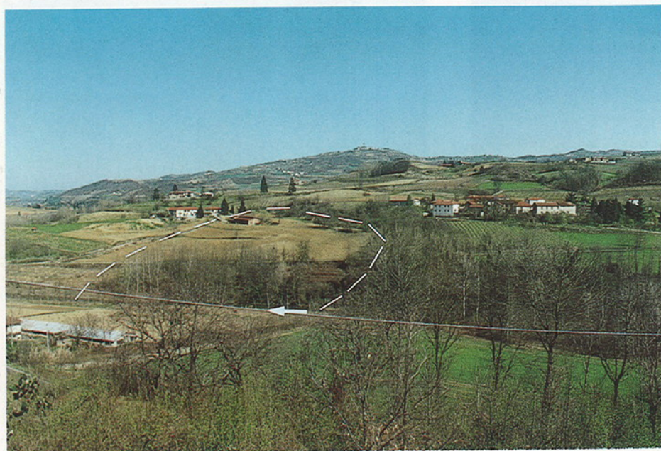
Fig. 1 - La frazione Chiappa fotografata dal versante sinistro del F. Bormida di Millesimo (indicato con la freccia). La linea tratteggiata evidenzia il limite della frana riattivatasi nel maggio 1924; il pendio collinare è stato sottoposto in seguito ad un intenso rimodellamento antropico che maschera ora l'originale scarpata principale e i fianchi della frana.
