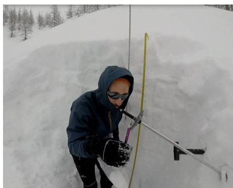
Figura 3.13: Esecuzione di un rilievo itinerante: pesata di una carota campione di uno degli strati identificati nel manto nevoso per determinarne la massa volumica.
