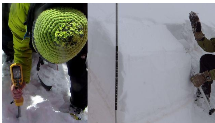
Figura 3.14: Utilizzo della sonda SP2 e test di stabilità (extended column test ECT).
