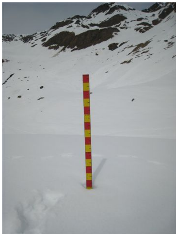
Figura 3.11: Asta per la misurazione della neve al suolo posta nel Campo neve manuale di Lago Vanino – Val Formazza (VCO) a 2177 m di quota.
