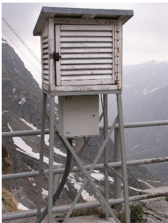
Figura 3.5: capannina per la misurazione dei valori di temperatura del campo di rilevamento neve manuale di Locana Telessio (TO) - 1917 m di quota.
