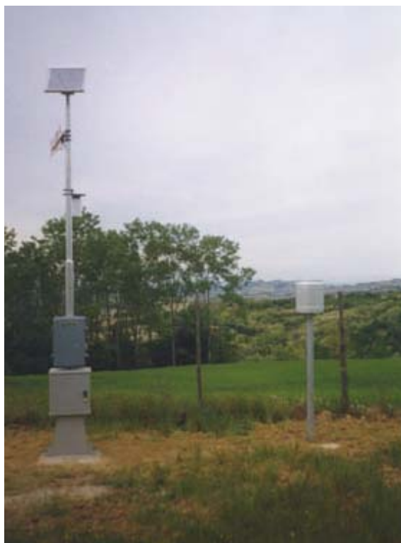
Figura I-5. Stazione termopluviometrica in teletrasmissione della Regione Piemonte
