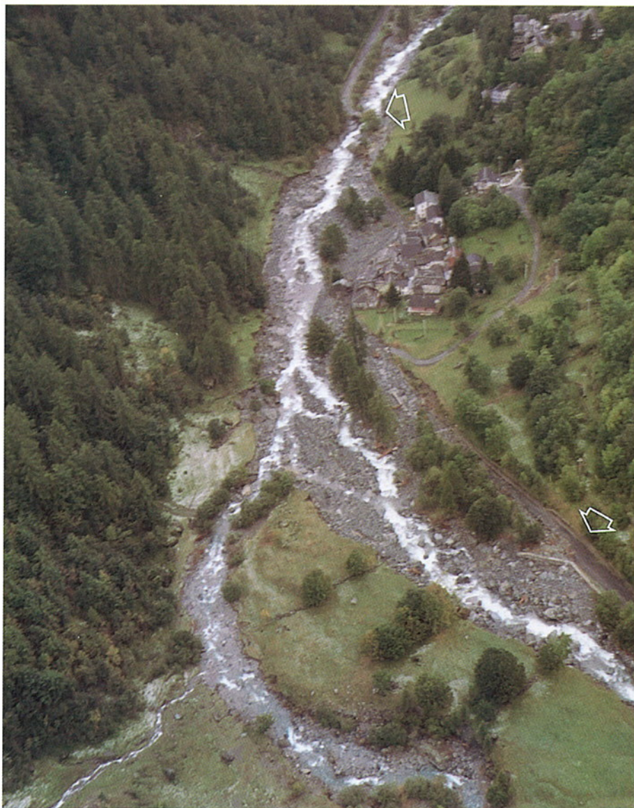
FOTO 37 - Valprato, frazione Ronchietto. Nel tratto compreso tra le due frecce la Strada Provinciale è stata sovrascorsa ed asportata quasi totalmente. Senso corrente dal basso verso l'alto.
