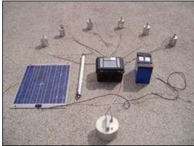
Fig. 39: Seismic array (Roth et al., 2006)
