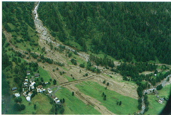
Fig. 46. Conoide interessata da processi di trasporto in massa indotti da eventi piovosi particolarmente intensi e concentrati. La miscela solido-liquida mobilizzata si è distribuita espandendosi in più lobi.
