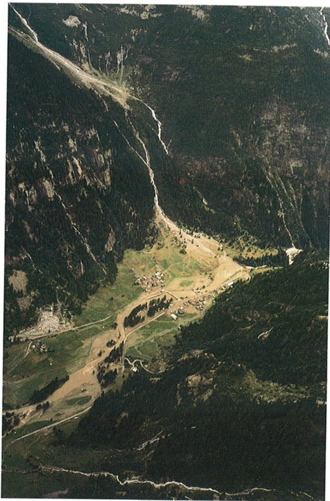
Fig. 47. La foto, relativa ad un ampio fondovalle alpino, mette in evidenza le aree inondate (fascia in colore nocciola) dal corso d'acqua in seguito ad un evento alluvionale. Sono visibili, come tracce più chiare rispetto al verde delle aree prative, le fasce di massima espansione raggiunte dalla corrente.
