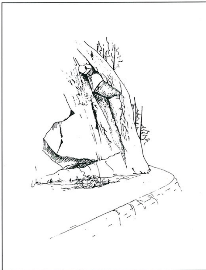
Fig. 29. I disegni evidenziano due situazioni prima e dopo il crollo parziale di una parete ad elevata inclinazione, intersecata da alcuni sistemi di discontinuità che hanno isolato una porzione rocciosa instabile rendendone cinematicamente possibile il collasso.
