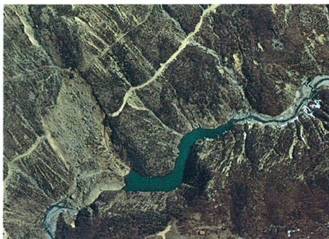
Fig. 10. Recente sbarramento di un corso d'acqua per frana di roccia e detrito; torrente Piota, in prov. di Alessandria, 19 marzo 1978. (Foto Alifoto).
