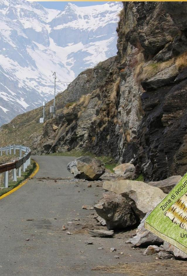
Con il termine frana si indicano tutti i fenomeni di movimento o caduta di materiale roccioso o sciolto, a causa dell'effetto della forza di gravità. Nella zona in cui si origina la frana si forma generalmente una nicchia di distacco, dalla quale il materiale scende lungo il pendio fino a depositarsi nella zona di accumulo.
