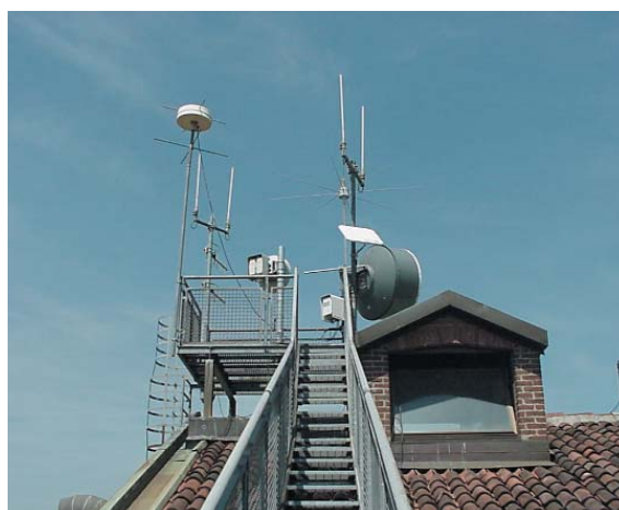
Figura 2.183 - La stazione meteorologica automatica portatile montata sul tetto della sede del WOC
