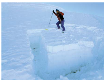
Figura 2.22 - Esecuzione test del blocco di slittamento - Rutschblock - per valutare la resistenza al taglio del manto nevoso
