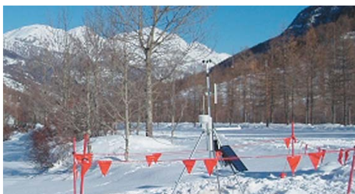
Figura 2.64 - Stazione meteorologica portatile installata nel punto più basso della pista, punto che variava a seconda del tracciato di gara, richiedendo di volta in volta lo spostamento della stazione portatile
