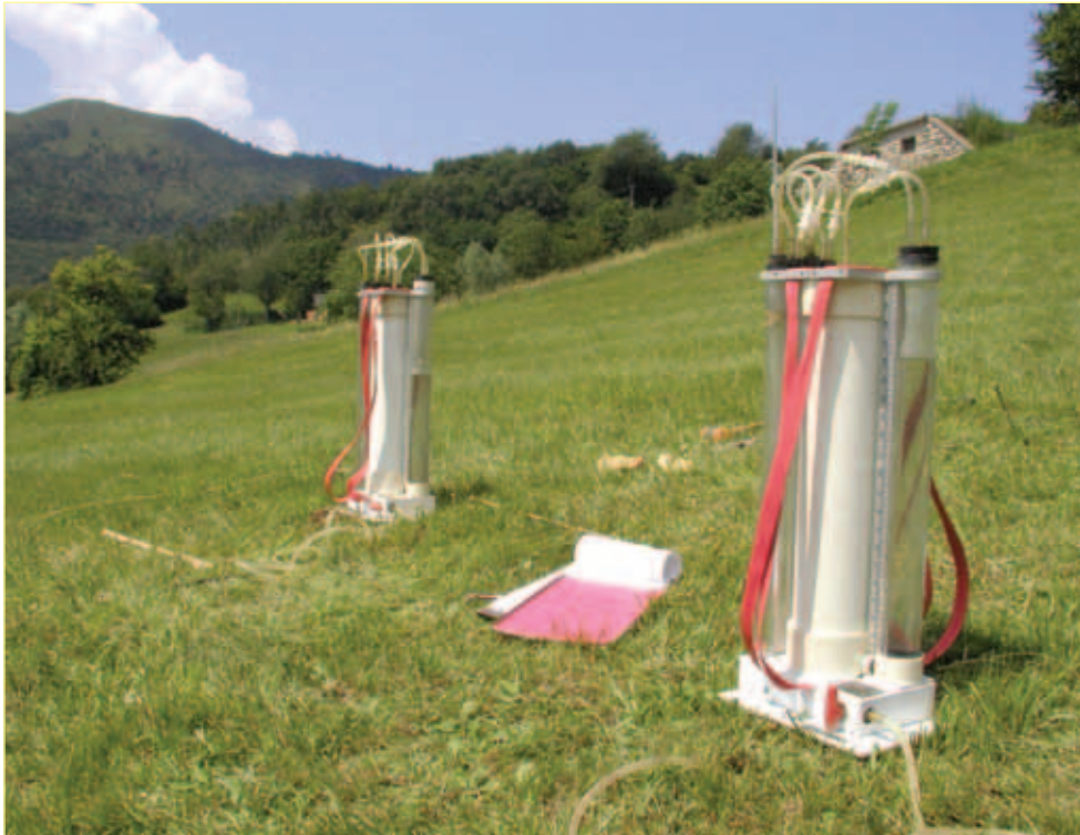
Figure APP1/2.3 Permeameters in the Commune of Zone – Place Cusato. Figur ANHANG1/2.3 Messgeräte für die Durchlässigkeit in der Gemeinde Zone – Cusato. Figura APP1/2.3 Permeametri in Comune di Zone – Località Cusato.
