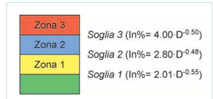
Figure 3.1.2.A/1.4 Definition of trigger thresholds (Ceriani et al., 1994; Agustoni, 1996). Figur 3.1.2.A/1.4 Definition der Auslöseschwellen (Ceriani et al., 1994; Agustoni, 1996). Figura 3.1.2.A/1.4 Definizione delle soglie d'innescio (Ceriani et al., 1994; Agustoni, 1996).
