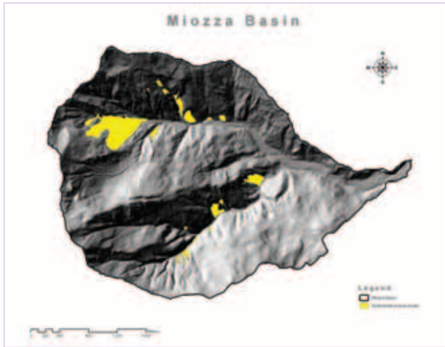
Figure 3.1.2.B/3.6 Erosion and landslide areas. Figur 3.1.2.B/3.6 Gebiete mit Erosion und Erdrutschen. Figura 3.1.2.B/3.6 Aree in erosione e in frana.
