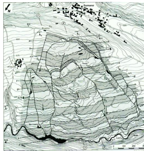
Fig. 10 - Il versante a N di Somano dopo il fenomeno di scivolamento del 13 marzo 1972 (restituzione da aerofotografie dell'aprile 1972).
