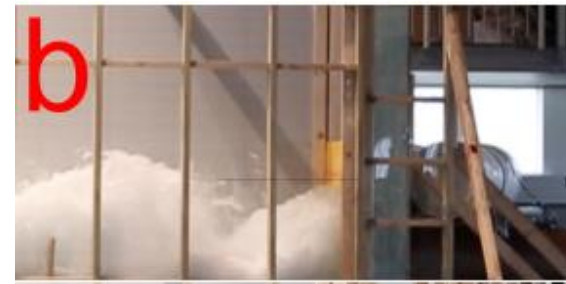
Flusso statico su barriera con risalto idraulico e jet su ostacolo a monte
