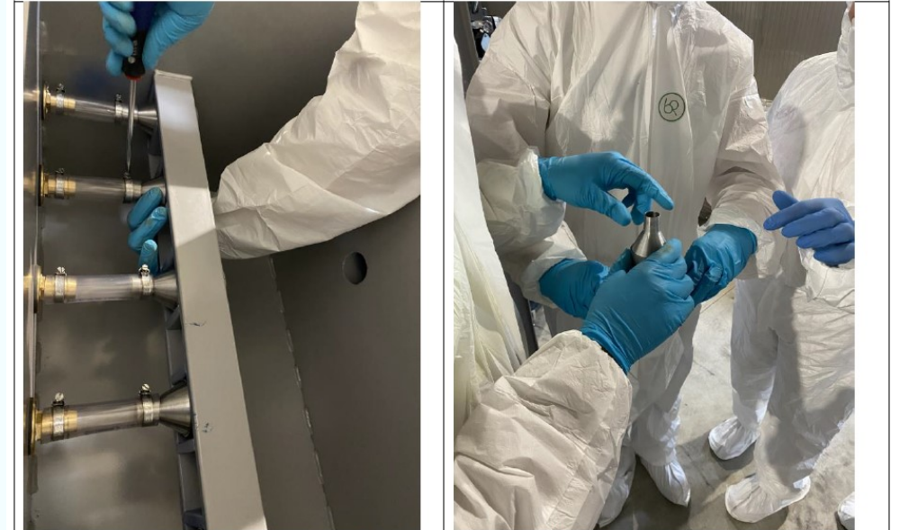
Smontaggio porta filtri (teste di prelievo) al termine dell'indagine sui rifiuti disassemblati e decontaminati e apertura porta filtro per recupero membrane
