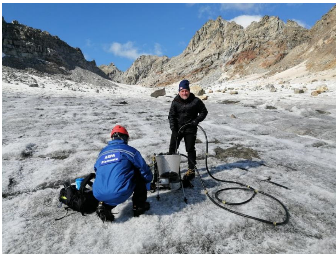
Figura 1 – Perforazione nel ghiaccio con sonda vapore per la sostituzione di una palina ablatometrica, ghiacciaio del Ciardoney, 17/09/2024 (foto SMI, http://www.nimbus.it/ghiacciai/2024/240920_CiardoneyBilancio.htm )
