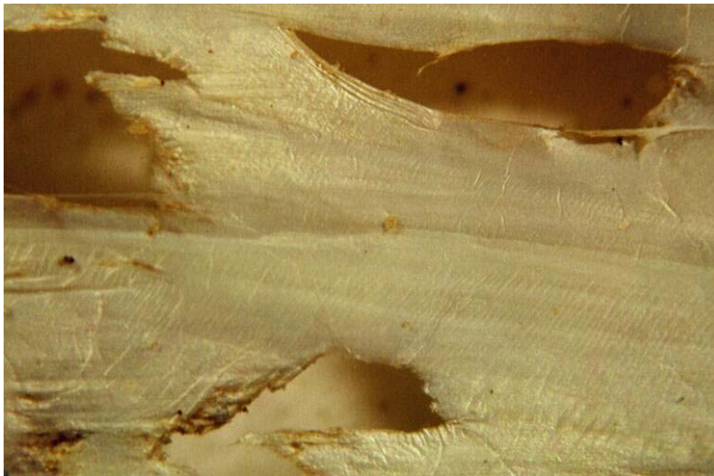
FRAMMENTO DI FASCIO SPESSO, “BUCATO” IN PIU’ PUNTI CON LA PINZETTA
