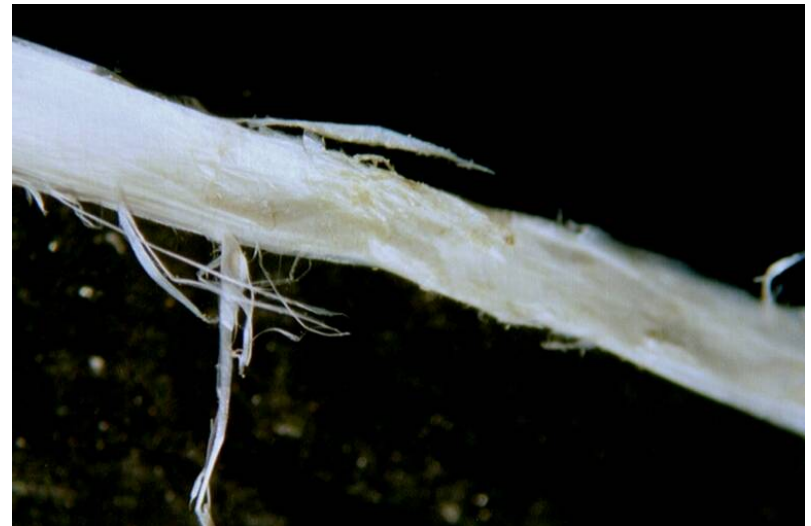
SRIBRATURADEL FASCIO (APERTO MANUALMENTE (AI FINI DIMOSTRATIVI), CON SEPARAZIONE DI FIBRE SOTTILI, EVIDENTEMENTE PIATTE
