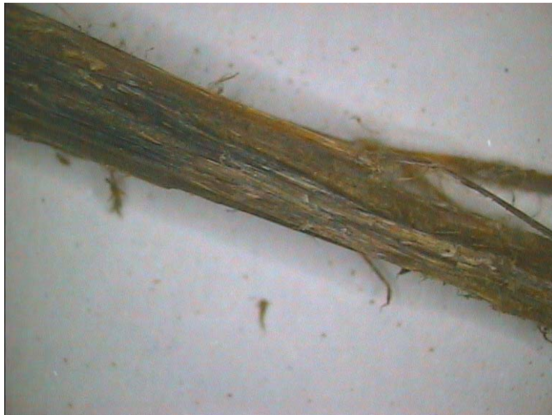
FASCIO FIBROSO CHIUSO; EVIDENTE LA SOMIGLIANZA CON LEGNO
