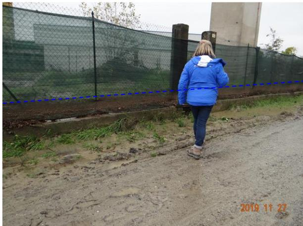
Figura 61. Altezza idrometrica di 70 cm raggiunta dalle acque del Bormida (linea tratteggiata)
