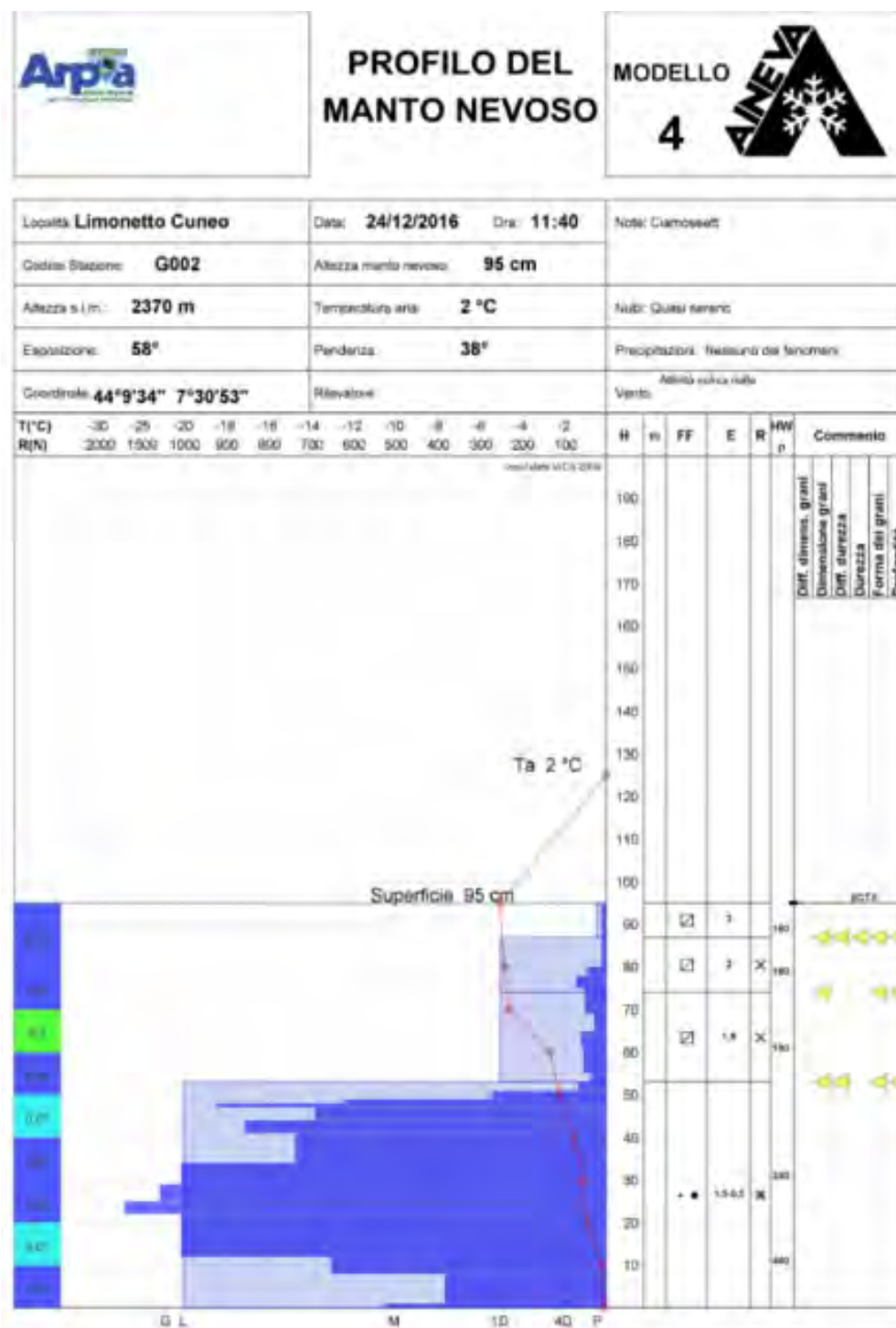
Figura 4.10: Profilo nivologico effettuato il giorno dopo l'incidente nei pressi della zona di distacco.
