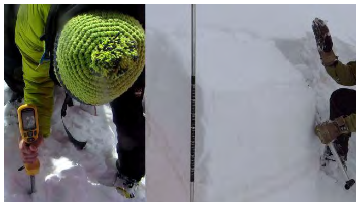
Figura 3.11: Utilizzo della sonda SP2 e test di stabilità (extended column test ECT).
