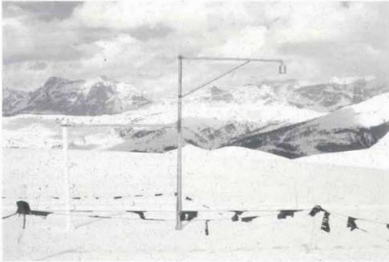
Fig. 1 Stazione nivometeorologica automatica; sulla destra si nota il nivometro ad ultrasuoni.
