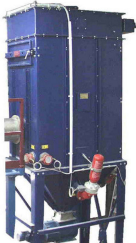
Soppressione dell'esplosione su una unità di filtrazione
