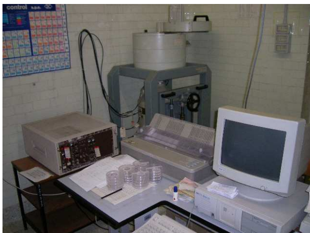
Figura 3 - Catena di spettrometria gamma utilizzata per le misure
