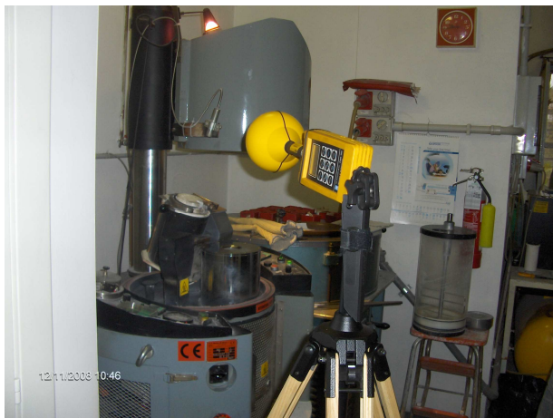
Figura 1 – fonditore ad induzione di metalli preziosi durante le misure.
