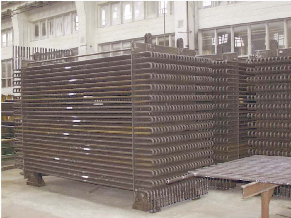
Fasci tubieri surriscaldatori a convezione
