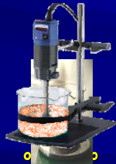
100 g di campione omogenizzati con 200 ml di acetone (20g).
