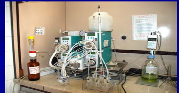
Purificazione mediante cromatografia a permeazione di gelli (GPC) mediante cromatografi a permeazione di gelli (GPC).
