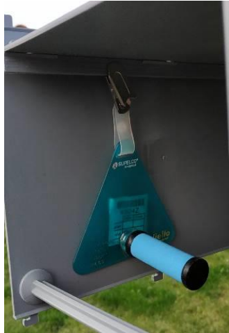
1) Fotografia di un campionatore passivo installato nel suo box di riparo dalle intemperie
