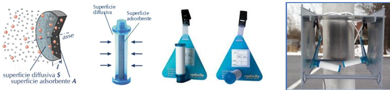
Ciascun campionatore viene esposto in campo, riparato da un box in polipropilene nel caso in cui non sia presente una copertura che protegga il dispositivo da eventi accidentali e/o atmosferici. Al termine dell'esposizione la cartuccia viene analizzata in laboratorio per ottenere la concentrazione media degli inquinanti rilevabili nel periodo di esposizione.
