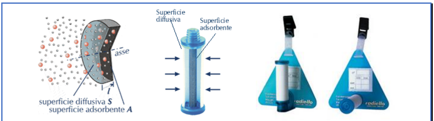
Schema di funzionamento di un campionatore passivo
