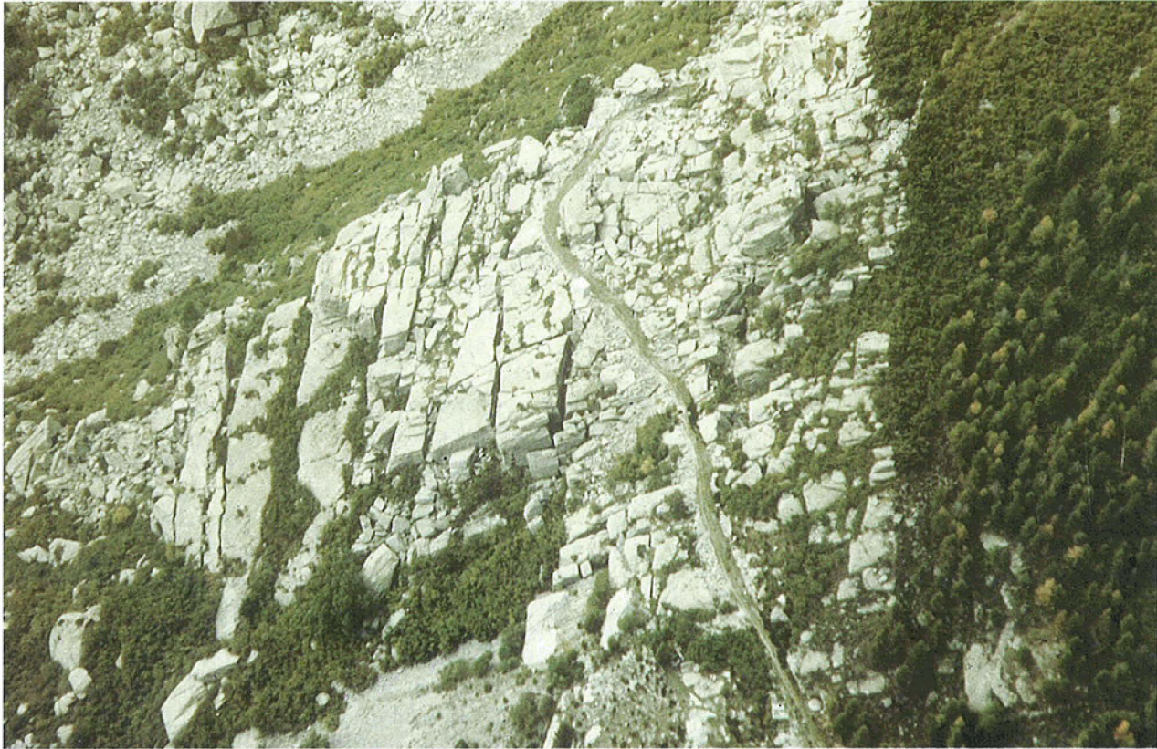
Fig. 8. Vista aerea della parte media del settore di Perebella con, in evidenza, i due principali sistemi di fratturazione presenti nell'area e diretti circa N-S ed E-W. Su quest'ultimo, diretto verso l'osservatore, si manifestano i movimenti deformativi più evidenti con creazione di scarpate in contropendenza.
