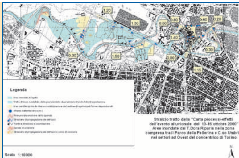
Figura 2.149 ◆ Stralcio cartografico tratto dalla "Carta processi-effetti dell'evento alluvionale del 13-16 ottobre 2000". Aree inondate dal fiume Dora Riparia nella zona compresa tra il parco della Pellerina e c.so Umbria nei settori ad ovest del concentrico di Torino
