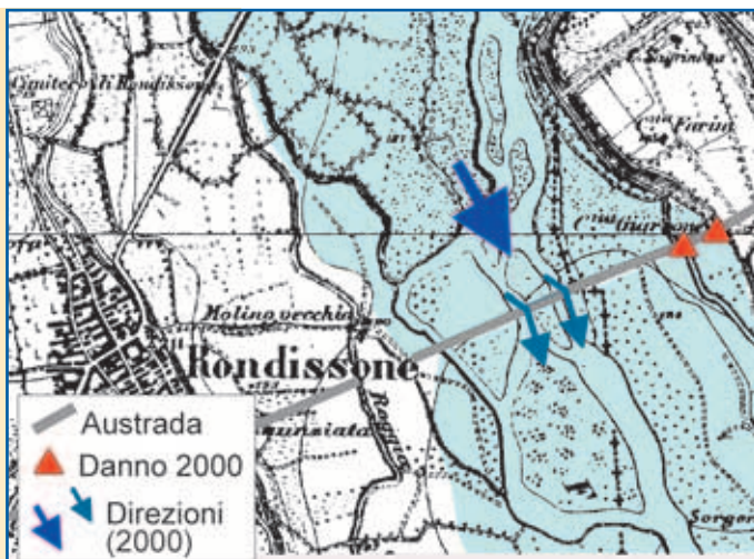
Figura 2.41 ◆ Base topografica a scala 1:25.00 (1858): si osserva l'andamento pluri- cursale del corso d'acqua.
