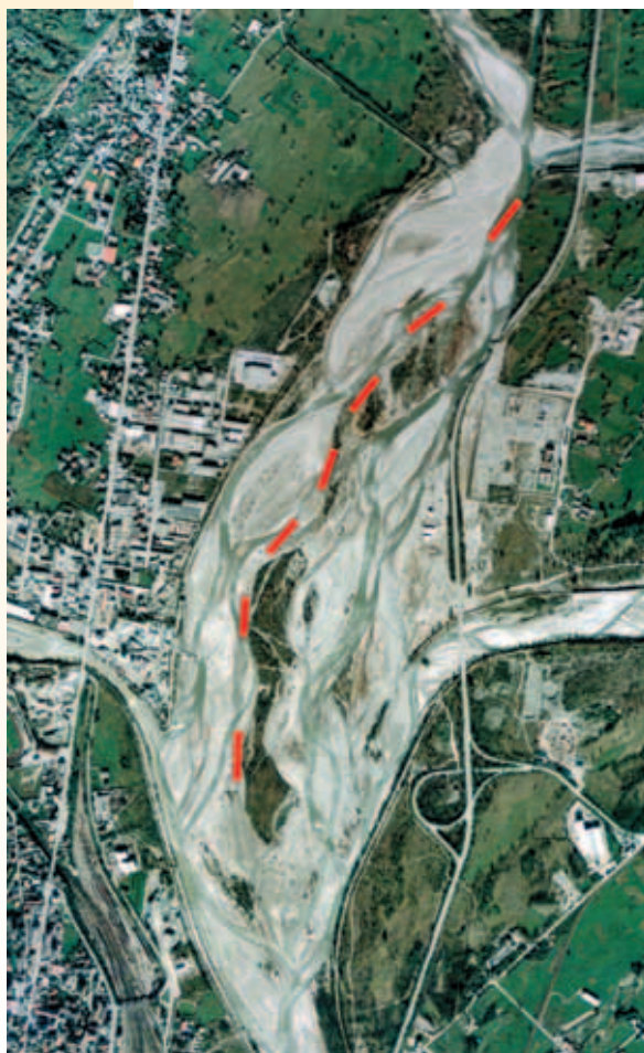
Figura 2.1 ◆ Comuni di Masera, Montecrestese, Crevoladossola e Domodossola. Direzione della corrente dall'alto verso il basso. Confluenze del Toce dei tributari: Diveria, Isorno, Bogna e Melezza Occidentale. Con il tratteggio rosso è indicata la ripa fluviale del letto di magra prima dell'evento. L'inondazione si è espansa in prevalenza in sinistra idrografica.
