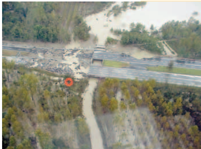
Figura 2.36 ◆ Zona in corrispondenza della frazione Marchetti di Pavone Canavese: le erosioni (nella foto) riprendono l'andamento del percorso del Ribes alla fine del XIX secolo (da cartografia IGM scala 1:25.000).
