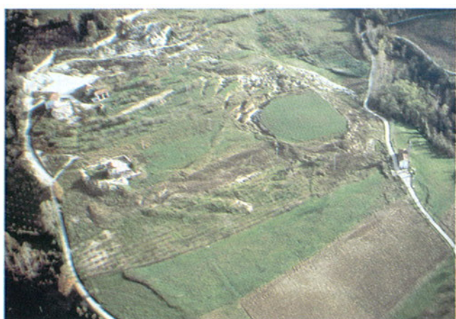
Fig. 16. Cissona, Località Madonna della Cassina. Vista aerea generale della frana per scivolamento planare: in alto la scarpata principale, in basso le ondulazioni derivate dalla compressione e da locale sovrascorrimento.
