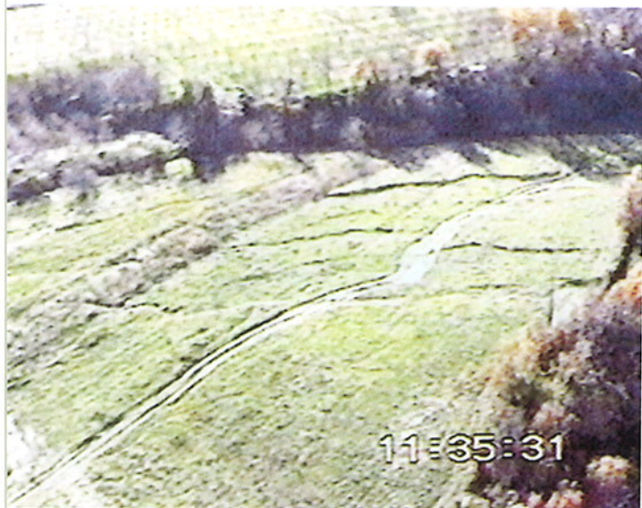
Fig. 3. Comune di Feisoglio, località Piazza. Poco a valle di una vecchia scarpata si sono delineate alcune fratture perimetrali legate all'attivazione del 1994.
