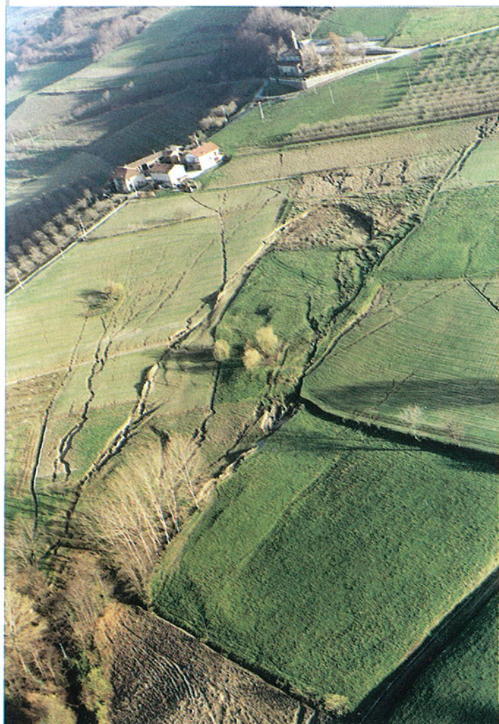
Fig. 13. Immagine in ripresa obliqua di uno scivolamento planare apparentemente arrestatosi in una fase iniziale, seppure ben delimitato da fratture laterali.
