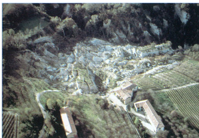
Fig. 15. Comune di Mango, località S. Ambrogio. La tipologia “libera piano-parallela”, alla quale appartiene questo processo, è definita “libera” dalla presenza di una sovraincisione al piede del movimento e “piano-parallela” dall'evidente parallelismo tra inclinazione degli strati e superficie topografica.
