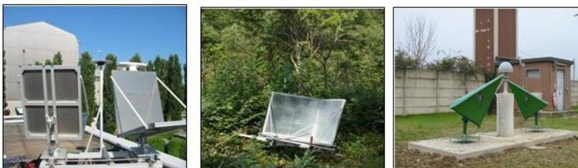
Figura 20: Principali tipologie di corner reflectors..
