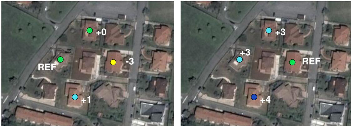
Figura 31: cambio di reference point. Nelle due immagini sono illustrate le velocità dei singoli PS utilizzando due punti di riferimento differenti. Da notare come indipendentemente dal punto scelto come riferimento, le differenze relative di velocità tra PS non cambiano.
