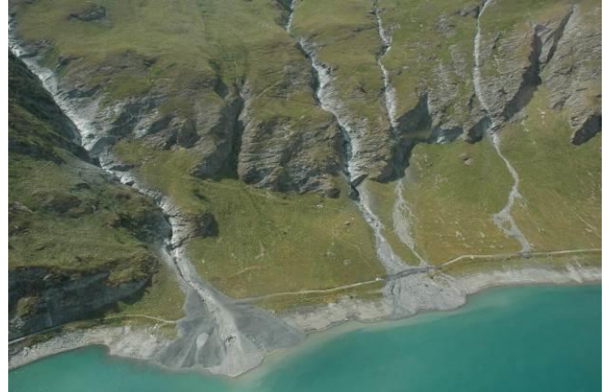
Figura 18 – A sinistra: parte alta del sottobacino Rio Pian dell'Acqua (comba Merdovine). A destra: fenomeni "secondari" di trasporto detritico incanalato sulla sponda destra del lago di Rochemolles.
