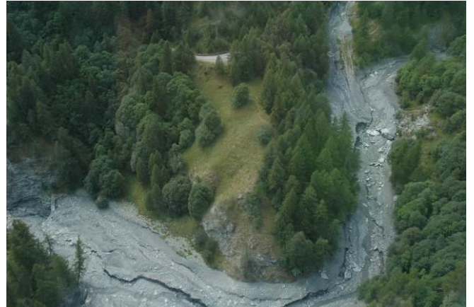
Figura 20 – A sinistra: frana in sinistra idrografica del rio Gautier. Non sono visibili attivazioni significative. A destra: erosione di materiale all'interno del T. Frejus, in corrispondenza della confluenza con il rio Gautier.
