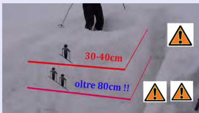
**Figura 2.29:** Risultato del test di stabilità del blocco di slittamento effettuato dopo l'analisi stratigrafica del profilo analizzato (estratto dal video del bollettino valanghe - [guarda il video](#) - per il fine settimana del **24-25 gennaio 2015**).
