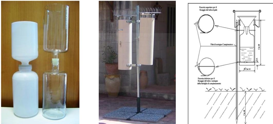
**Figura 28 – sistema di raccolta non presidiato ISTISAN 06/38 - Deposimetro – foto e rappresentazione schematica installazione bulk**
