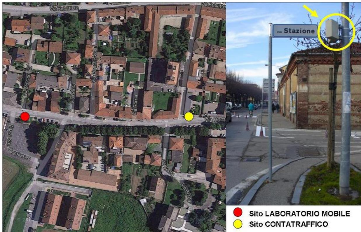
Il conta-traffico utilizzato nei rilevamenti è del tipo GmbH - modello viacount II. Si tratta sostanzialmente di un apparecchio per il monitoraggio del traffico composto da un sensore radar "Doppler" da 24.165 GHz con memoria dati integrata e orologio in tempo reale. Il sensore radar misura a scelta i movimenti dei veicoli di una o di entrambe le direzioni di marcia; nel nostro caso le misure sono state eseguite conteggiando i veicoli in entrambe le direzioni di marcia.
