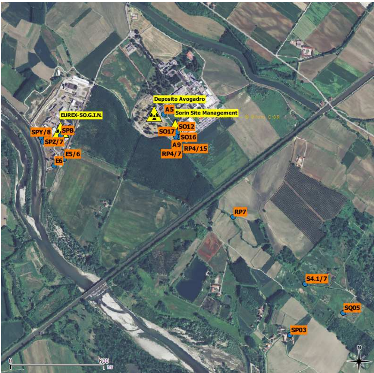
Figura 5.1 Distribuzione dei punti di campionamento dell'acqua di falda nel Comprensorio nucleare di Saluggia.
