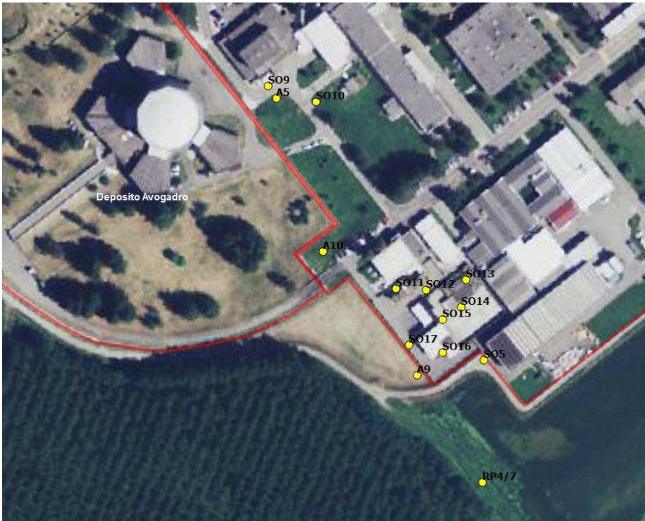
Figura 2 Dettaglio della distribuzione dei punti di prelievo dell'acqua di falda all'interno del Complesso Sorin.
