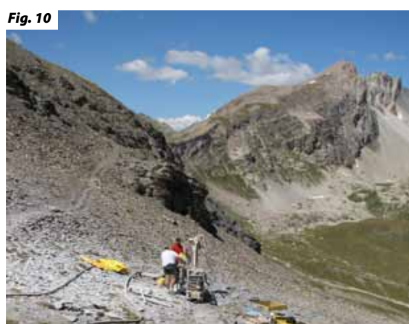
Figura 10. Perforazione del pozzo profondo 30 m in cui sono inseriti i termometri per misurare l'andamento termico nel sottosuolo.
