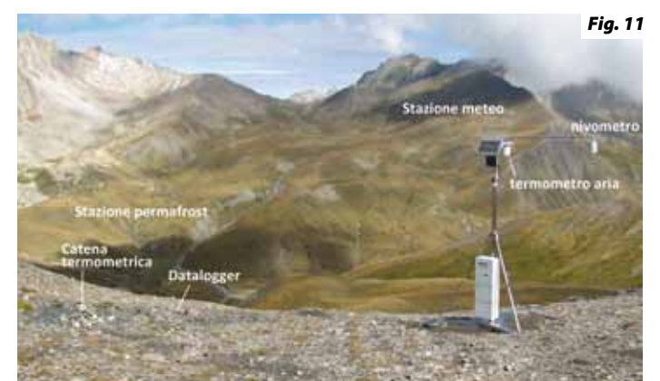
Figura 11. Stazione di monitoraggio del permafrost del passo de La Colletta (situata sotto la superficie) affiancata alla stazione meteorologica della rete regionale gestita da Arpa Piemonte, dotata di sensori per misurare la temperatura dell'aria e l'altezza della neve al suolo (nivometro).
